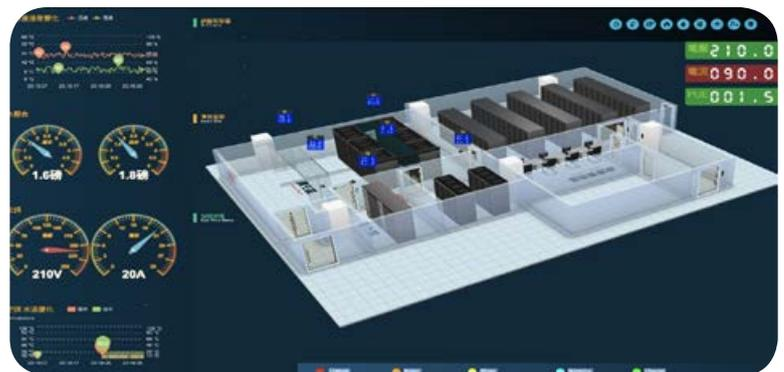
同時，機房亦建置DCIM資料中心智慧管理平台 (Data Center Intelligent Management, DCIM)，以3D虛擬實境畫面全天候即時呈現所有機房設施運作狀態，包括供配電系統、空調系統、溫度溼度偵測、消防系統、影像監視及門禁系統等，
